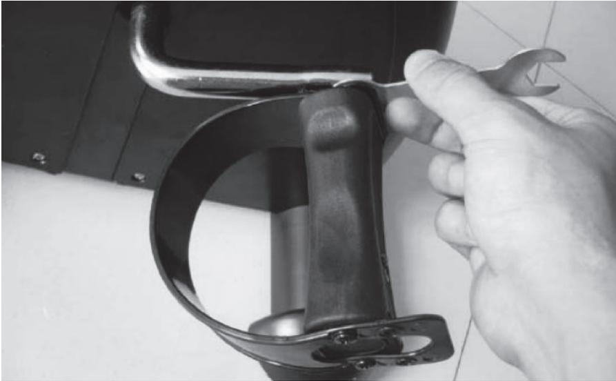
3. Befestigen Sie nun die beiden Pedale (4 & 5) am Hauptgerät. Das rechte Pedal ist mit R gekennzeichnet, befestigen Sie es am rechten Ende des Kurbelarms (12). Schrauben Sie das rechte Pedal im Uhrzeigersinn fest. Das linke Pedal ist mit L gekennzeichnet. Schrauben Sie das linke Pedal gegen den Uhrzeigersinn fest.
